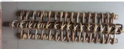
Photo 2: Répartition des armatures en rotin sur celles en rônier [2]
