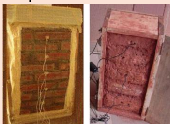
Figure 1 : Mur en brique de terre cuite (gauche) et en brique de latérite taillée (droite)
