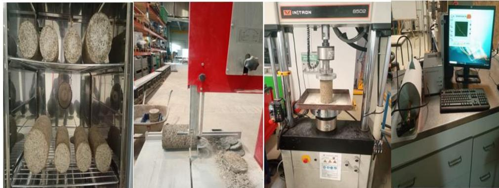
Figure 1: méthodes de caractérisation thermique et mécanique des échantillons
