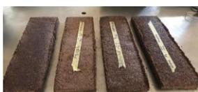
**Fig. 1. Plaque obtenue après compactage**
