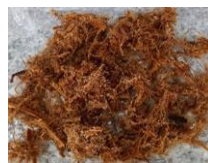
Bagasse de canne à sucre traitée au NaOH
