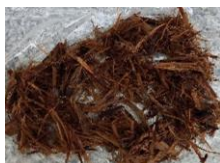
Bagasse de canne à sucre traitée thermiquement
