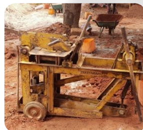
Fig. 8: Presse de compactage
